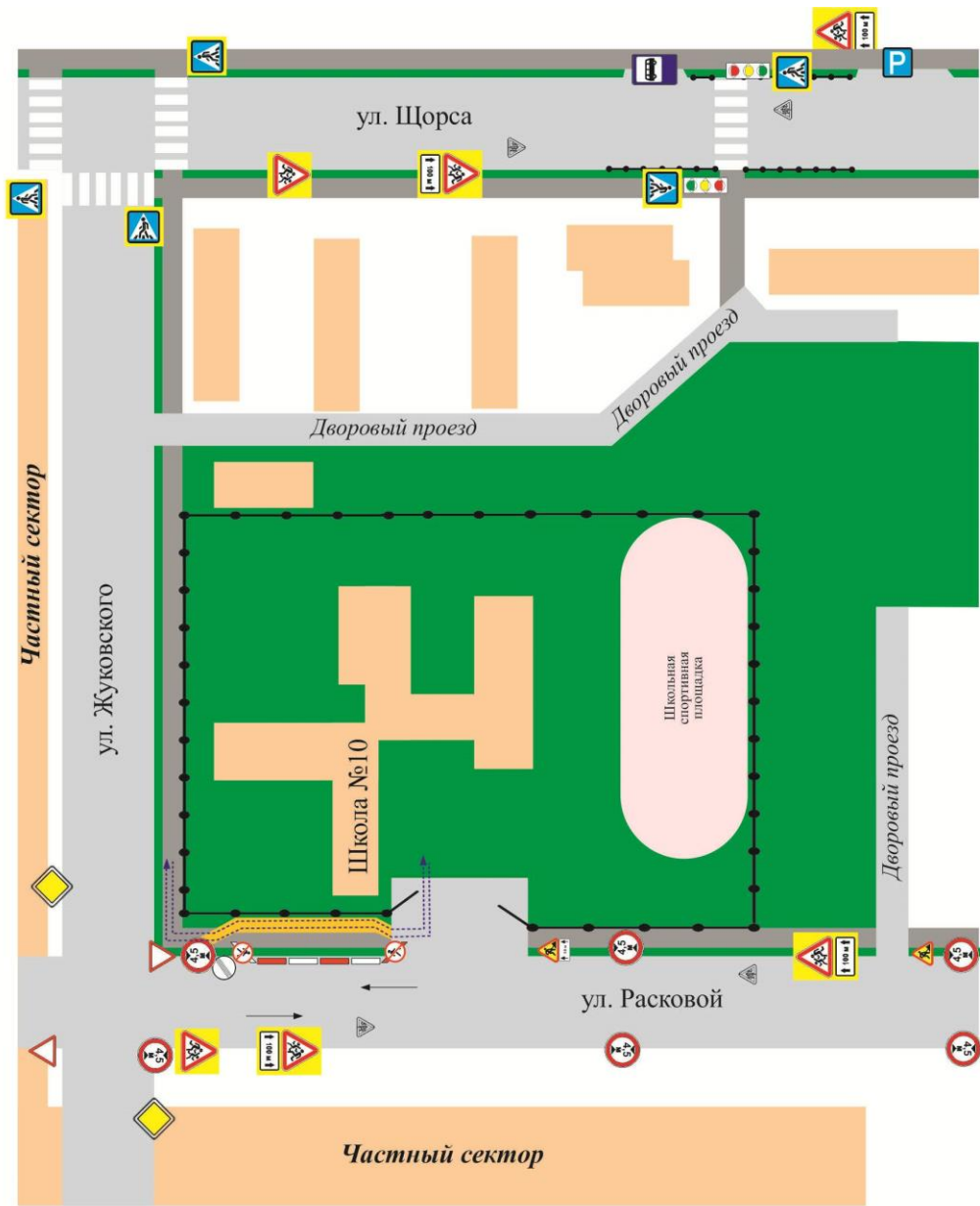
План-схема пути движения транспортных средств и детей при проведении дорожных ремонтно-строительных работ вблизи ГБОУ СОШ №10
